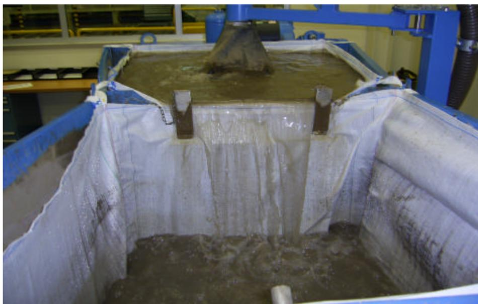
Filter- und Absetzvorgang in der Standard MBM- ASAS
